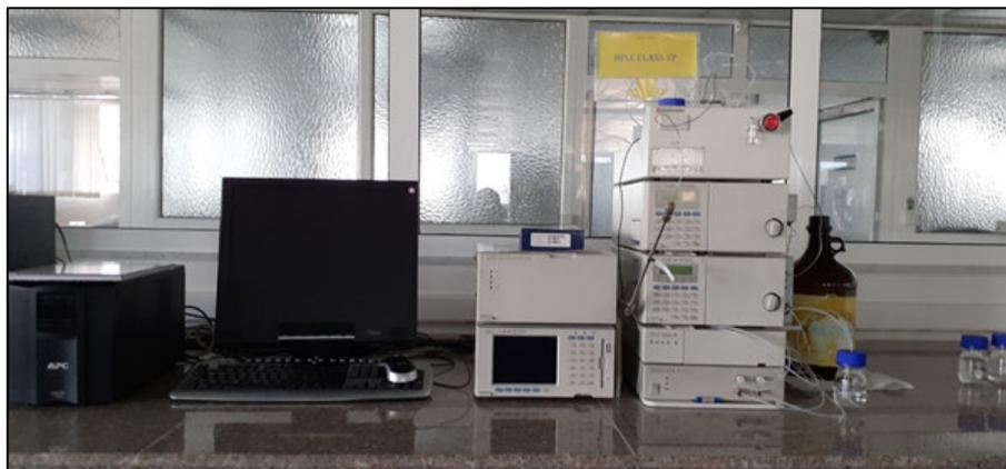
**Figure (26) :** La Chromatographie Liquide à Haute Performance (HPLC)
