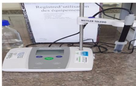
Figure (24) : Le conductimètre (METTLER TOLEDO SEVNEASY)
