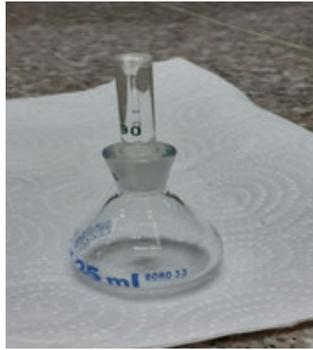
**Figure (30) :** Le pycnomètre.
