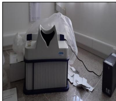
**Figure (29) :** Spectrophotomètre UV.
