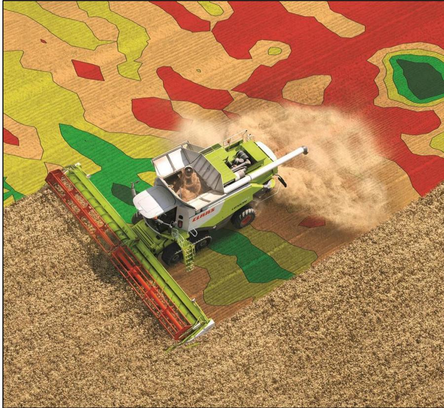
**Figure 01** : Cartographie de rendement à partir des mesures réalisées par la moissonneuse-batteuse en combinant un capteur de rendement sur l'élevateur et le GPS, l'ordinateur de bord de la moissonneuse-batteuse établissait une carte de rendement (*Source* : lafranceagricole.fr)
