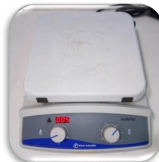
**Figure 5 :** Plaque magnétique agitateur.
