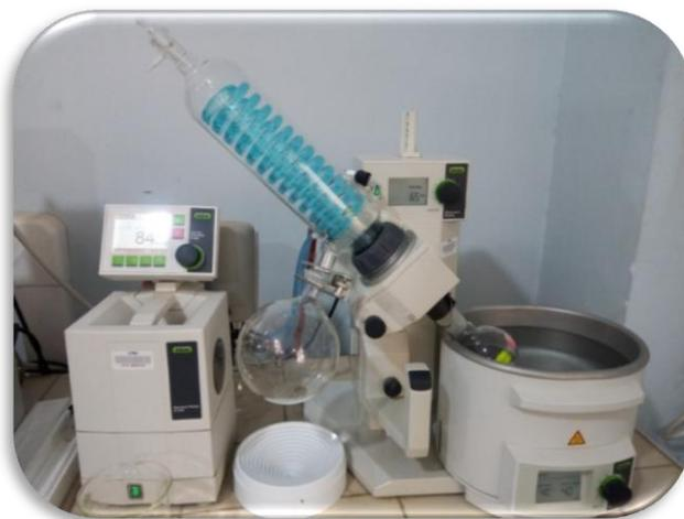
**Figure 2 :** Evaporateur rotatif.
