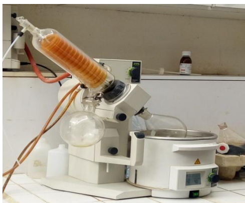
Figure7: Evaporation sous vide a l'aide d'un rota vapeur.
