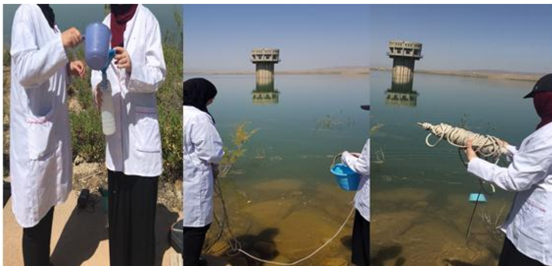
Figure 4 : mode de prélèvement des échantillons d'eau (Aoussat & Guernane, 2019).
