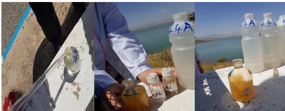
Figure 8 : Fixation de l'oxygène dissous sur site (Aoussat & Guernane, 2019).
