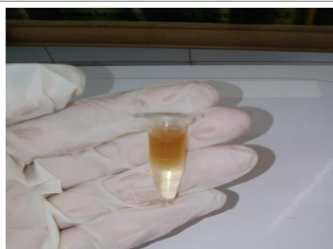
Photos. 4 : Récupération des cellules à partir des échantillons de prétraitement et l'aspect du mélange culot + CTAB après la centrifugation (le 04/05/2019).
