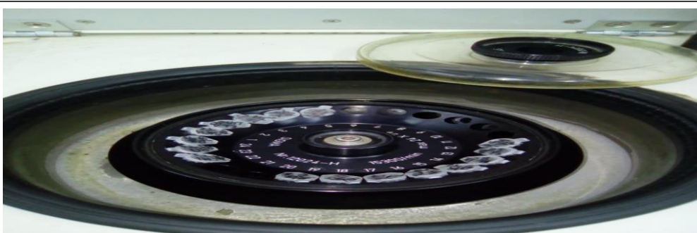
Photos. 5 : Centrifugation des échantillons à 16\,000 \times g , 4^\circ\text{C} (le 04/05/2019).
