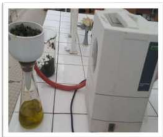
Figure A,40: Filtration sous vide à l'aide d'un Büchner (photo original).
