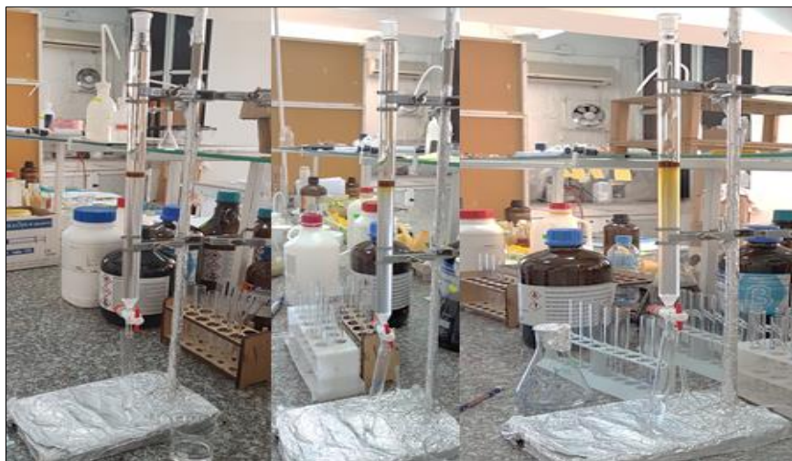
Figure 27 : Evolution de la chromatographie sur colonne de gel de silice de la fraction (136-137-138).
