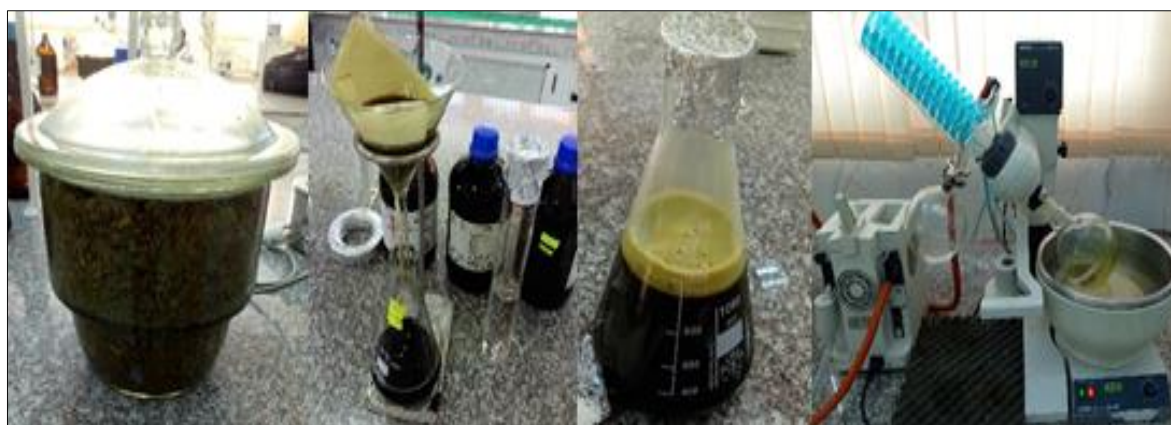
Figure 23 : Les différentes étapes de macération, de filtration et d'évaporation de l'extrait hydroalcoolique de la plante Astragalus armatus willd.
