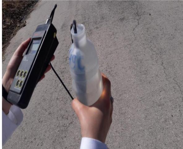
**Figure 7 : Mesure de la CE in situ.**
