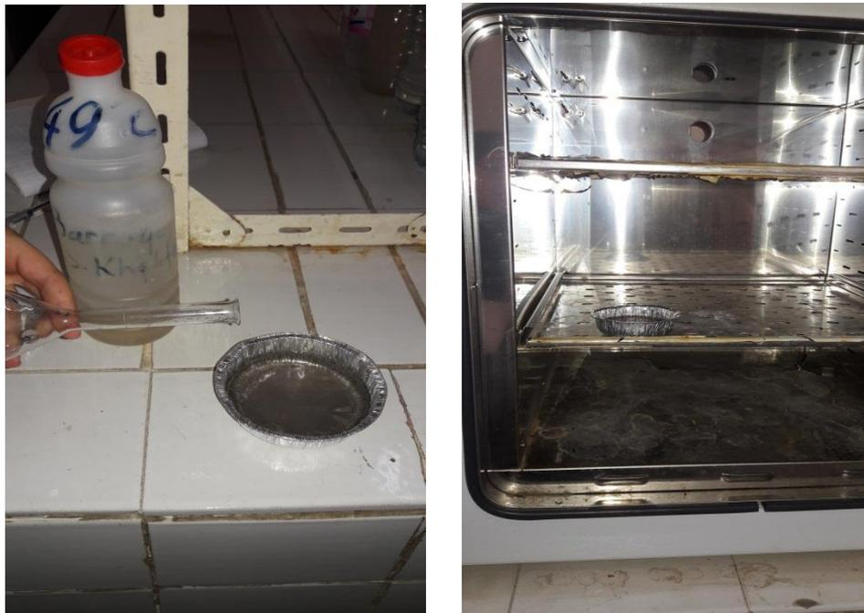
Figure 9 : la détermination du Résidu Sec
