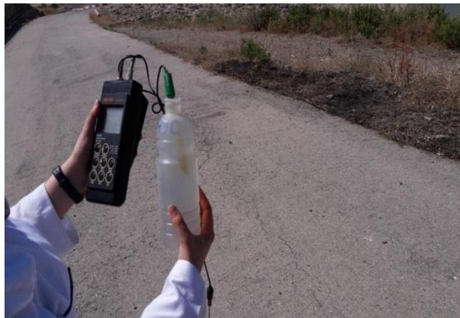
**Figure 6 : Mesure du pH in situ.**
