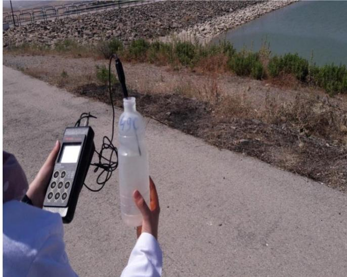
**Figure 5 : Mesure de la température in situ.**
