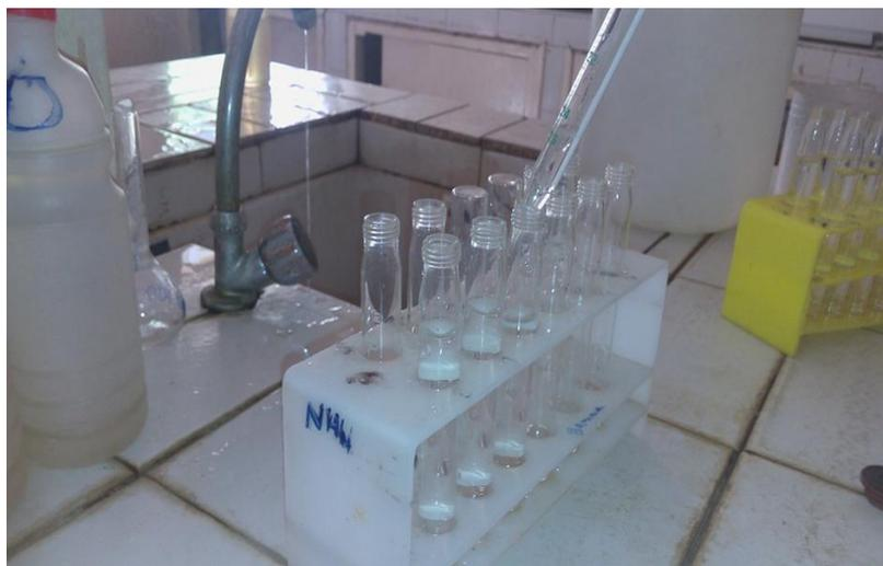
Figure 12 : Dosage de L'ammonium dans l'eau
