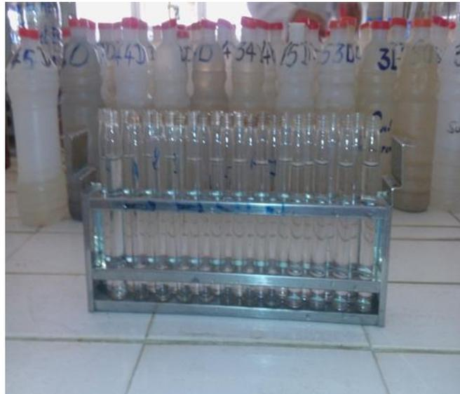
**La figure 15 : Dosage des phosphates dans l'eau**
