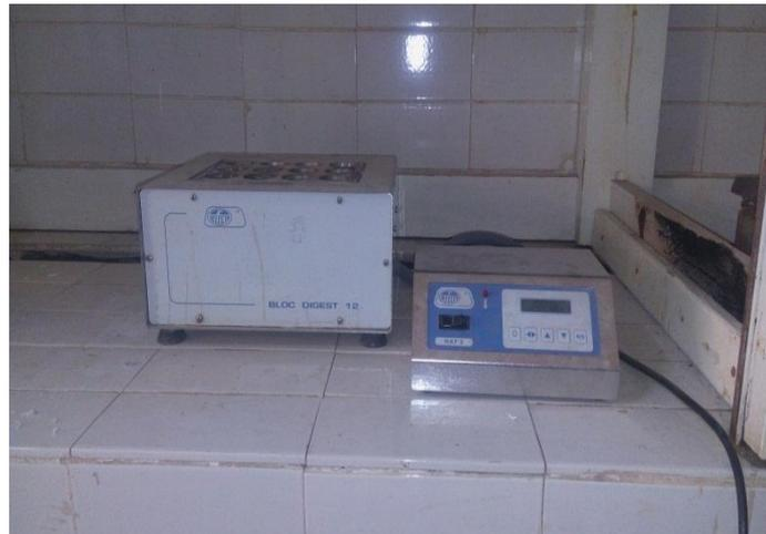
Figure 11 : l'appareil de mesure DCO
