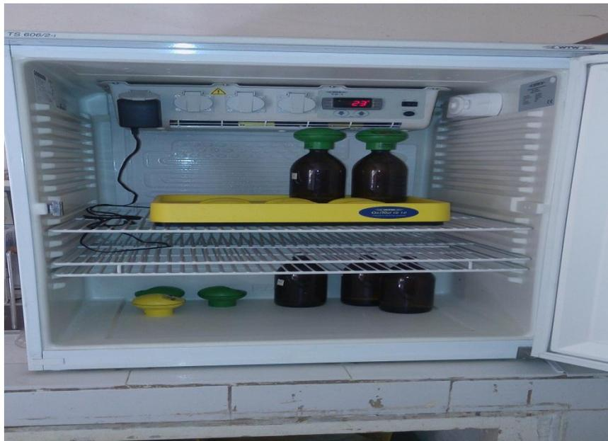
**Figure 10 : l'appareil de mesure DBO<sub>5</sub>**
