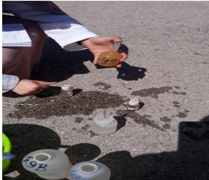
**Figure 8 : Mesure de l'Oxygène dissous in situ.**
