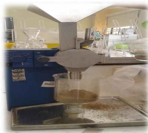
**Figure 11** Broyage de la plante par l'appareil MF 10 basic Micro-broyeur.
