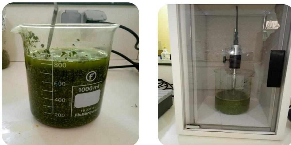
**Figure17** : Extraction solide/liquide des feuilles par macération et ultrason.
