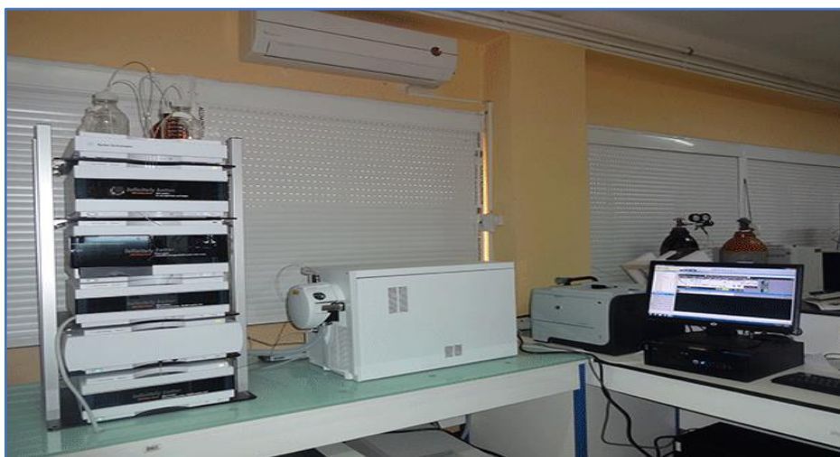
Figure II.3. Système quaternaire de l'HPLC.
