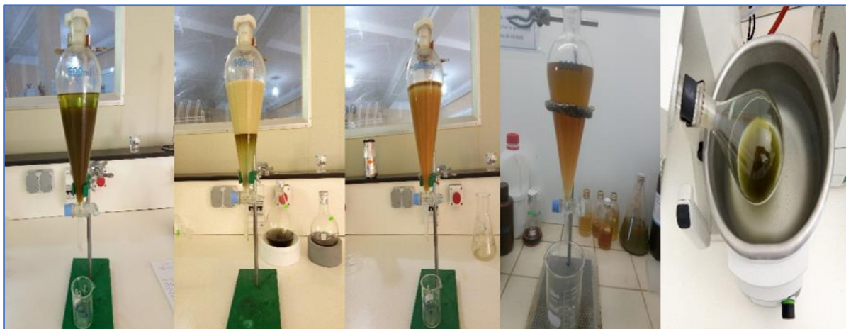
Figure II.6. Etapes d'extraction liquide-liquide et procédé de concentration de chaque extrait.
