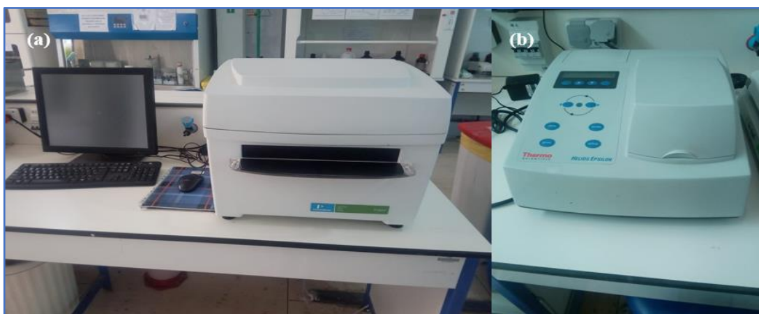
Figure II.2. Spectrophotomètres UV-visible. (a) lecteur de microplaque Perkin Elmer, (b) spectrophotomètre à cuve.
