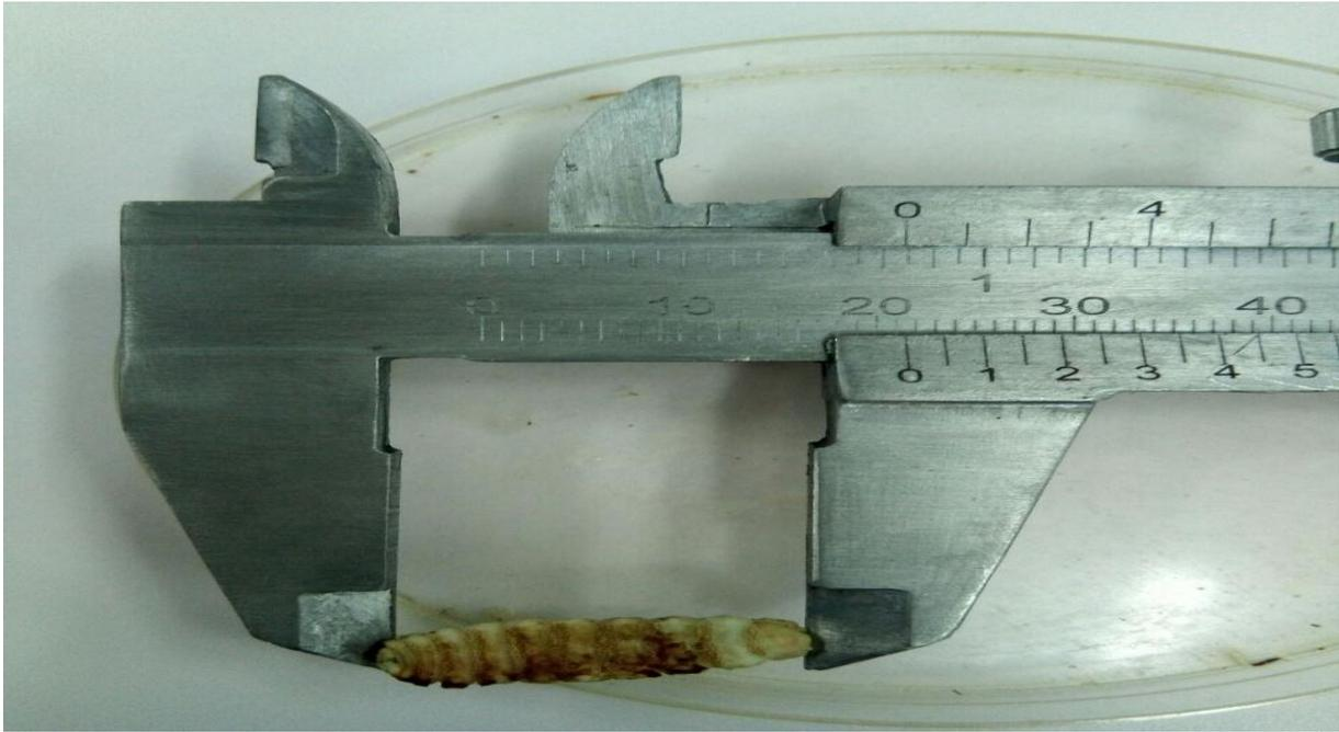
**Figure 44** : représentation de la mesure de la longueur de la L2 (original)
