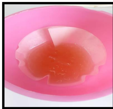
Figure 12 Filtration de la masse mycélienne par papier filtre wattman n°1.
