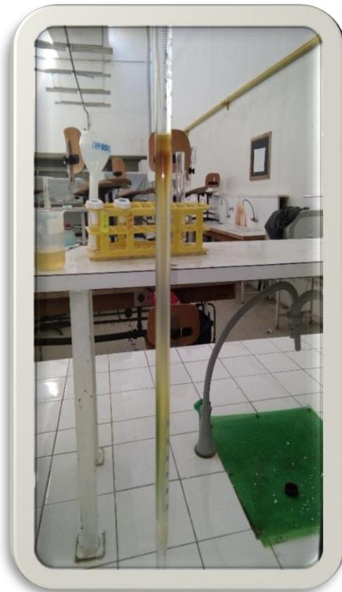
Figure 11 : Fractionnement de l'huile totale par chromatographie sur colonne du gel de silice
