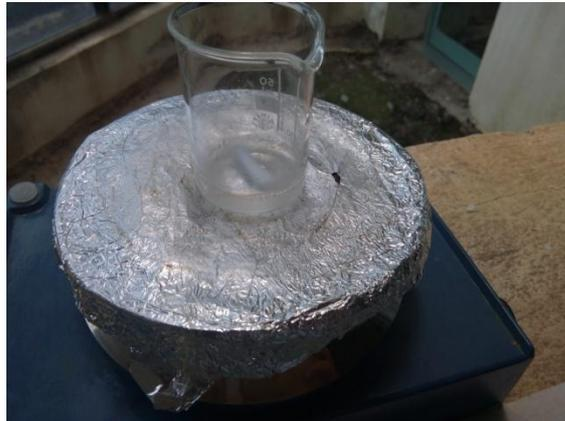
Figure11 : Seconde agitation après l'ajout de 20% du sulfate d'ammonium
