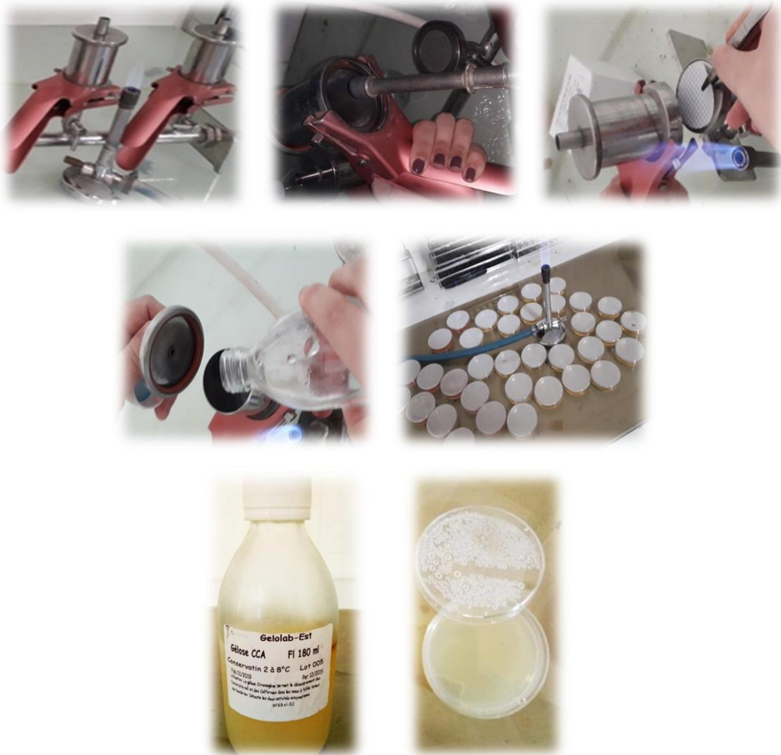
Figure 07 : Processus de filtration et dénombrement des Coliformes totaux et d' E. coli
