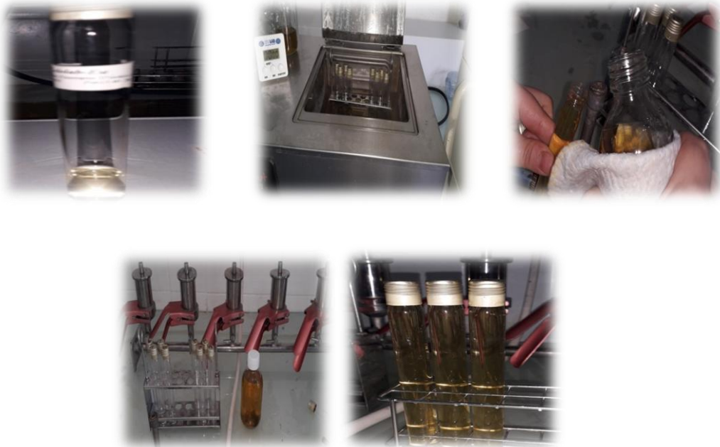
Figure 11 : processus de filtration et dénombrement des Clostridium sulfito-réducteurs
