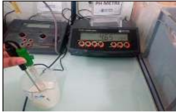
Figure 12 : détermination du pH par un pH-mètre
