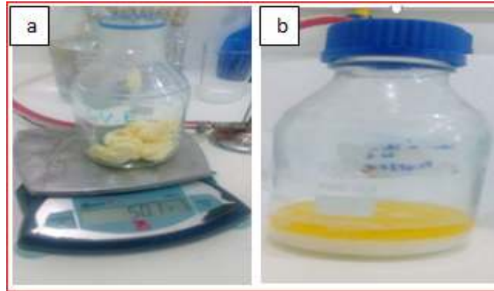
Figure 7 : Traitement de l'échantillon du beurre. a; la fonte du beurre sur la plaque chauffante, b; séparation de la phase aqueuse et la phase grasse.
