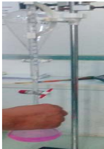
Figure 4 : Détermination de l'acidité titrable.
