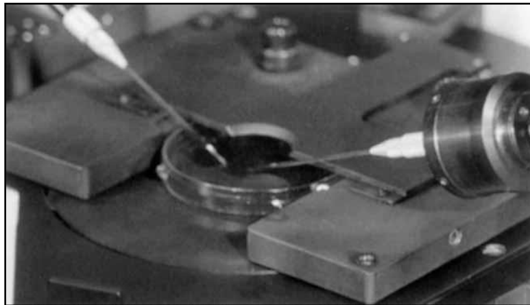
Figure. 9 : Microscope avec l'équipement de micromanipulation et les micro-injecteurs.
