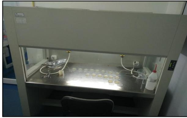
**Figure 2 : Hotte à flux laminaire**
