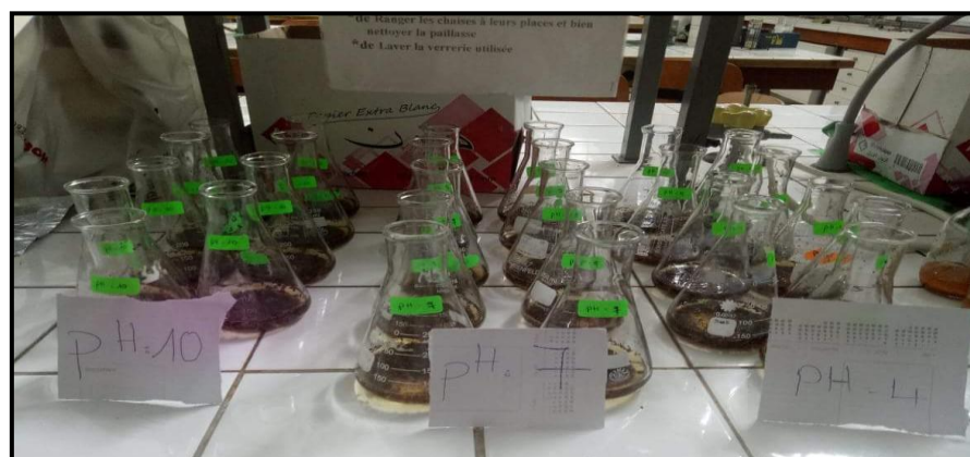
Figure23 : Technique du préparation du milieu de fermentation à base de déchets de bananes
