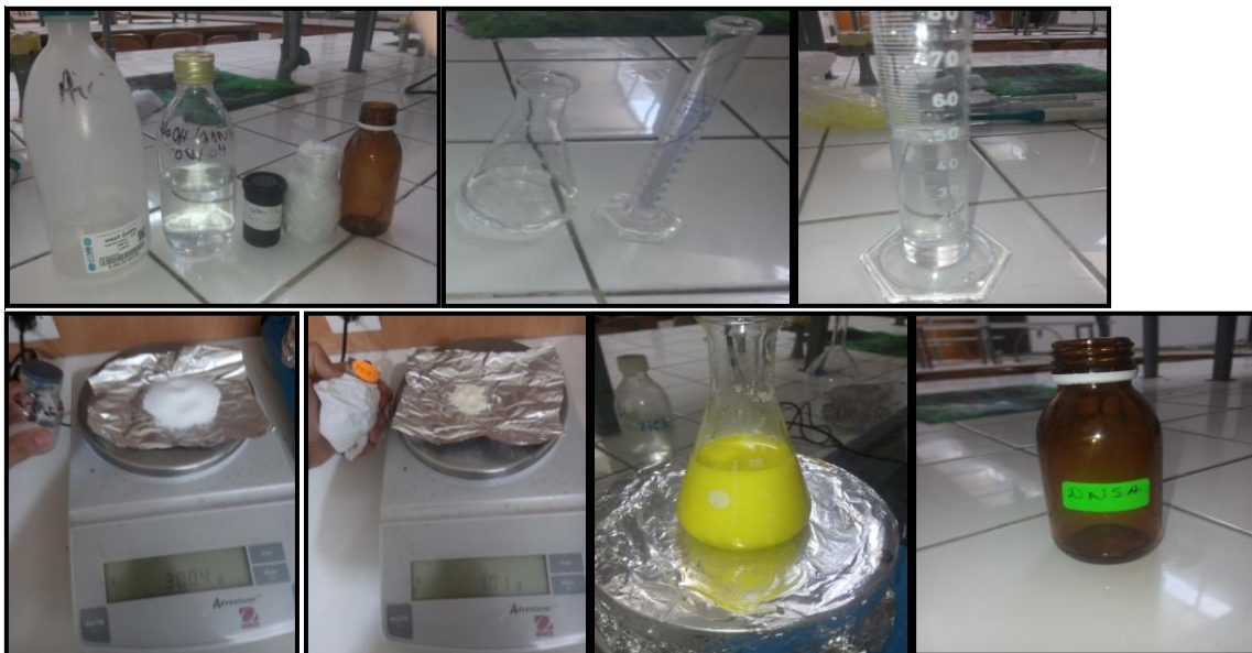
Figure 31: technique de préparation de DNSA
