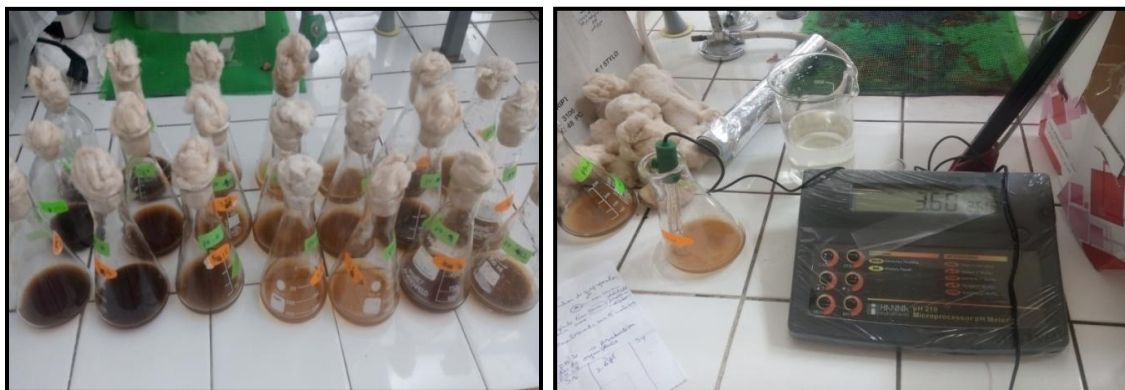
Figure25 : mesure le pH mètre de l'extrait enzymatique de chaque pH (4, 7 ,10).
