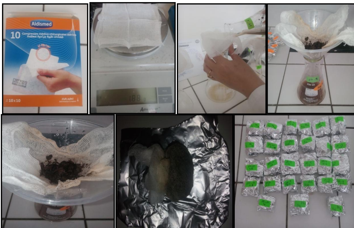
Figure 37 : technique du filtration de la biomasse
