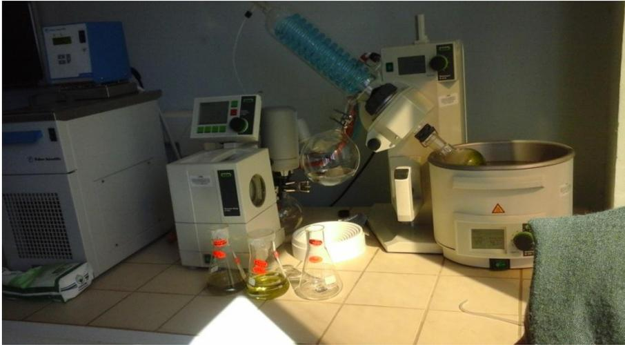
Figure3.13:séchage avec la rota vapeur
