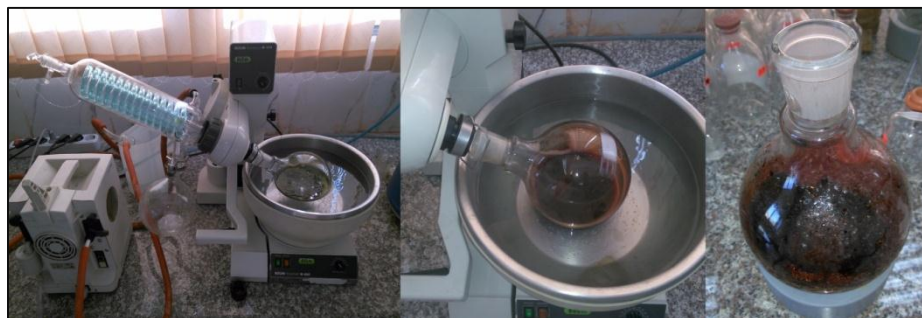
Figure 21 : Procédé de concentration des filtrats hydroalcooliques
