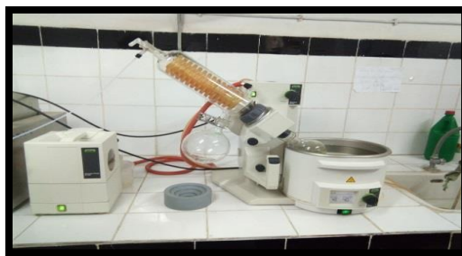
Figure 14 : Evaporateur rotatif de type BUCHI R-210 (Photo originale).
