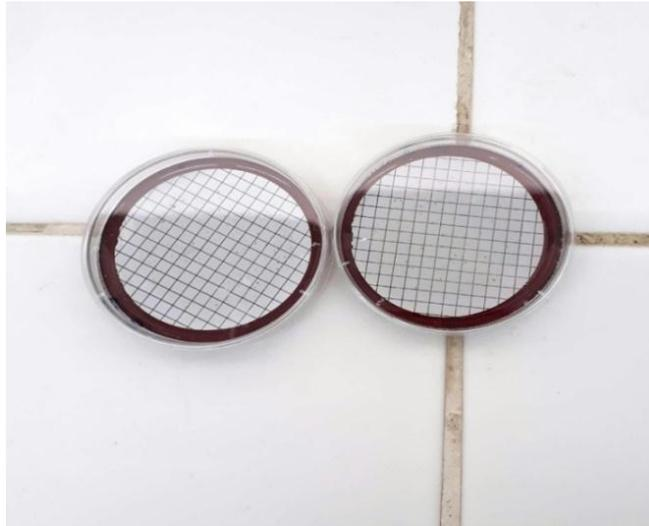
**Figure 13 :** Les deux boîtes de Pétri avec les filtres à membrane avant incubation
