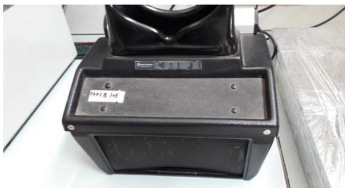
**Figure 36:** Observation des chromatogrammes sous UV
