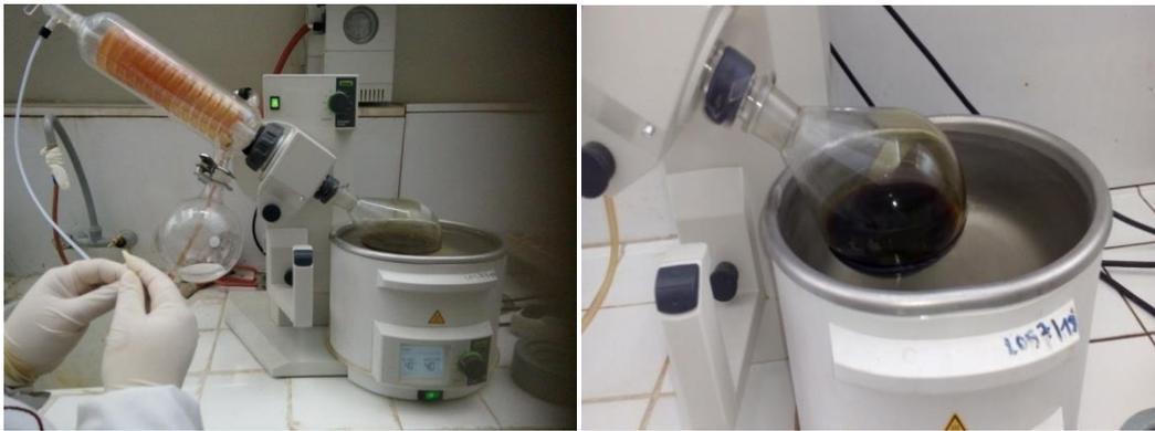
**Figure 38:** Evaporation par rotavapor
