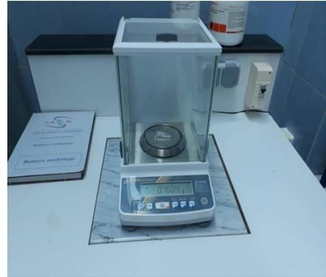
Photo.02: Prise de mesure du poids par une balance de précision.
