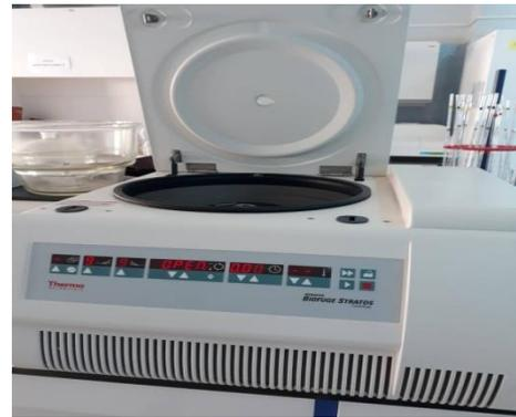
Photo.04: Mettre les tubes dans l'appareil de centrifugation.
