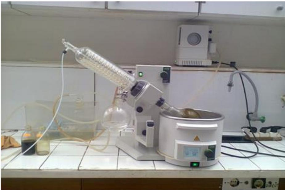
**Figure 11: photographie représentant un appareil Rotavapor**
