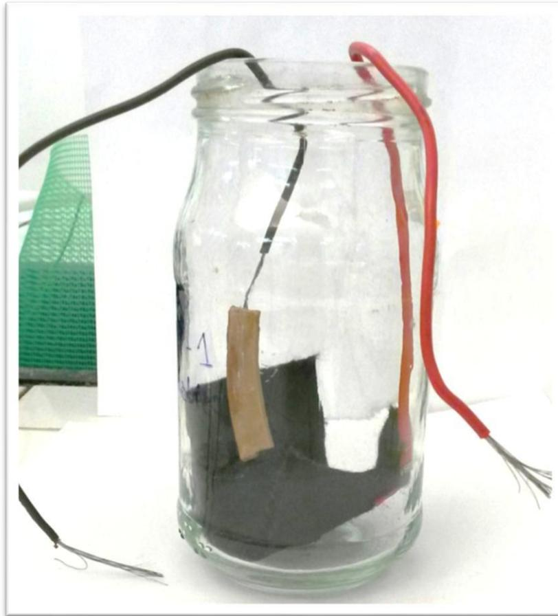
**Figure27** : le montage général des électrodes de la pile microbienne.
