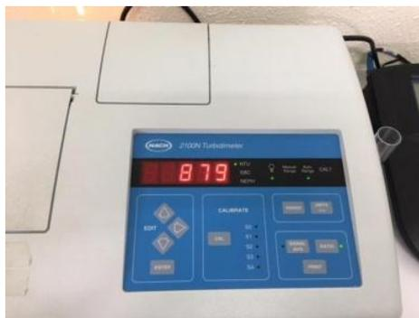
**Photo 3 :** Turbidimètre de type 2100N-HACK
