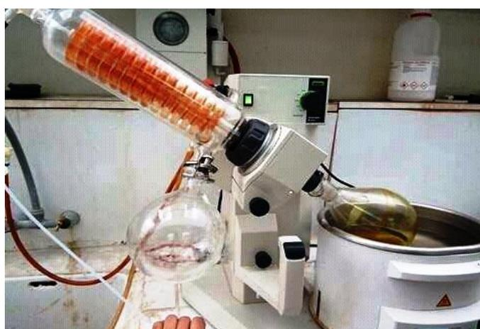
Figure 4 : Evaporation à l'aide d'un rota vapeur.
