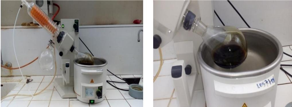
**Figure 43 :** Evaporation par rotavapor
