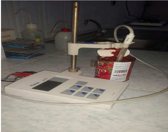
Figure 07 : Mesure du pH à l'aide d'un pH mètre
