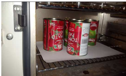
Figure 10 : Incubation des boîtes de conserve à 30°C
