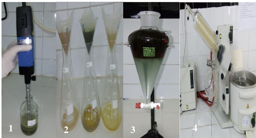
Figure 12 : Etapes d'extraction des métabolites des souches du genre Aspergillus : (1). Extraction par le chloroforme ; (2). Filtration ; (3). Décantation, (4) évaporation.
