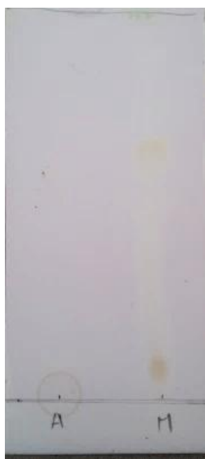
Figure 22. Chromatographie sur couche mince des extraits des feuilles du Zizyphus lotus (Révélation par une solution de DPPH)
