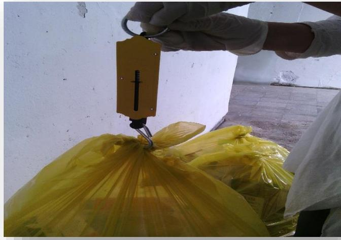
**Figure 08 : instrument de pesée (0-25kg)**
