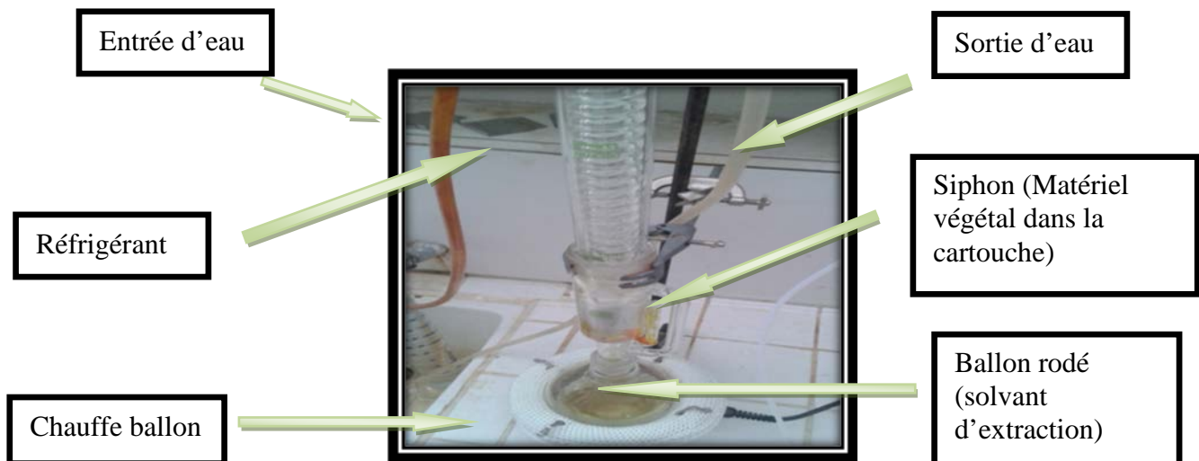
Annexe01 : Soxhlet de labo biochimie
