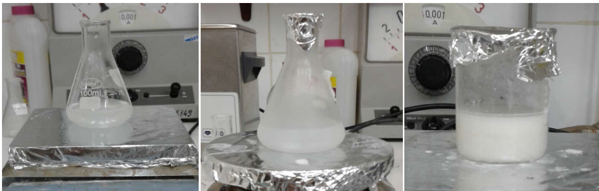
Figure 12 : La solution blanche obtenu par la technique de précipitation des poudres de ZnO et MgO.
