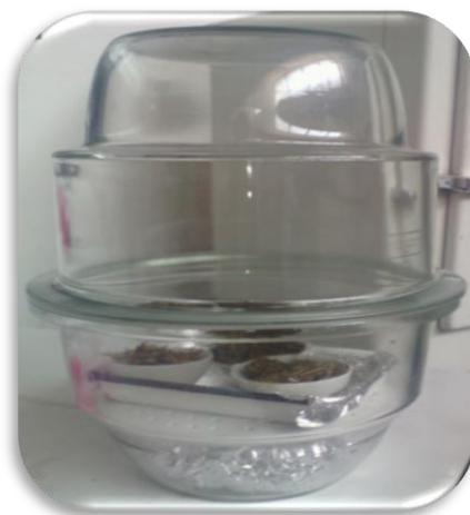
**Figure 19** - Matière sèche dans le dessiccateur après séchage.
