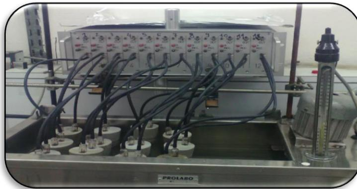
Figure 22 - Appareil de mesure du gaz en anaérobiose.
