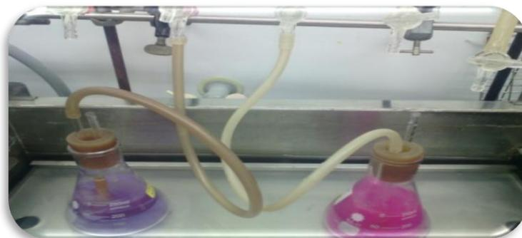
**Figure 20** - Réduction du milieu d'épuisement sous CO<sub>2</sub>.
