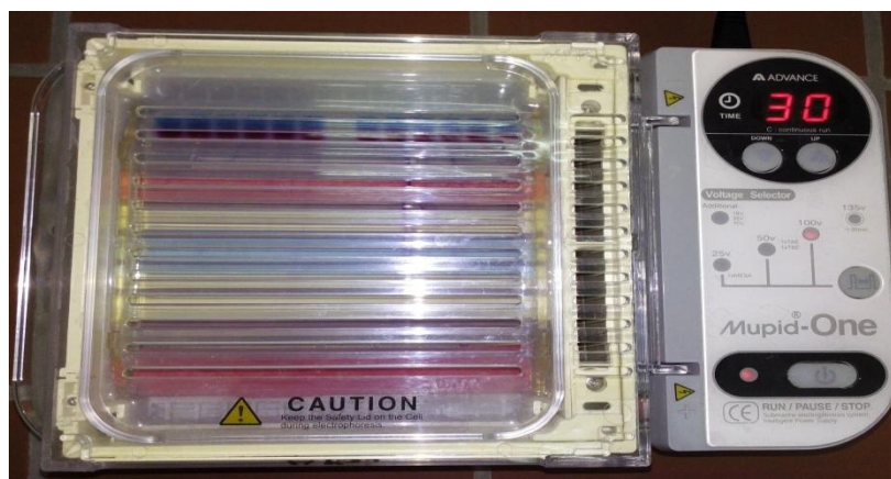
Image 10 : Migration des échantillons par électrophorèse sur gel d'agarose 0.8%, 30 mn à 100V
