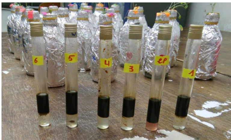
Figure 11 : Variation du taux d'émulsification d'une souche à un autre et entre les différents types d'hydrocarbures.
