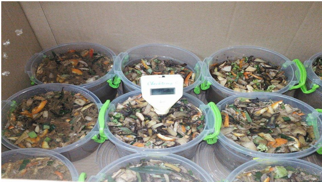
Photo 7 : La sonde utilisée pour la mesure des TC°.
