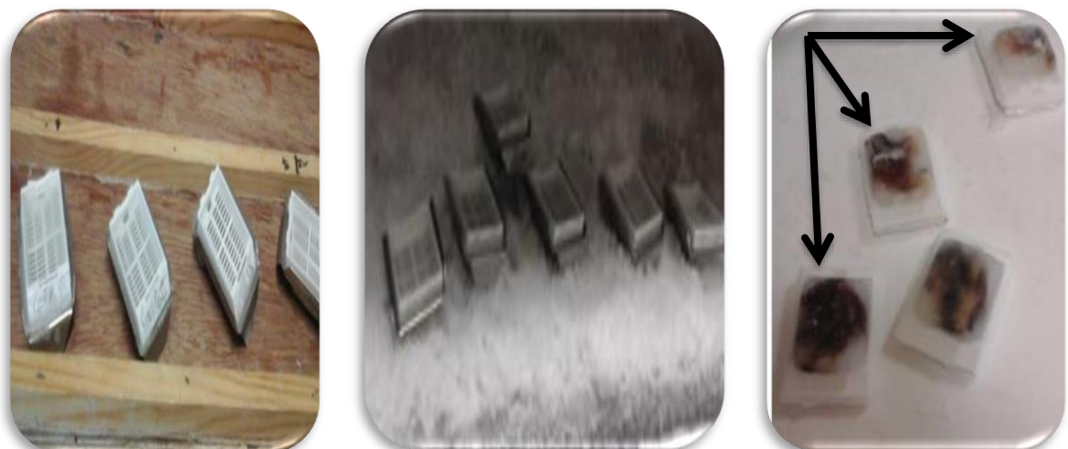
Figure. 6: Refroidissement des pièces et obtention des blocs solides de paraffine (Flèches noires).
