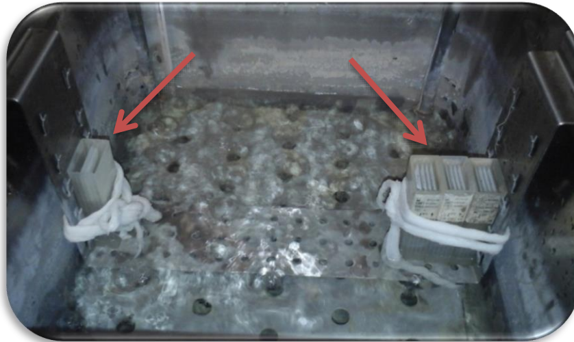
Figure. 12: Les becs à solution de démasquage avec les lames sont dans le bain marie.
