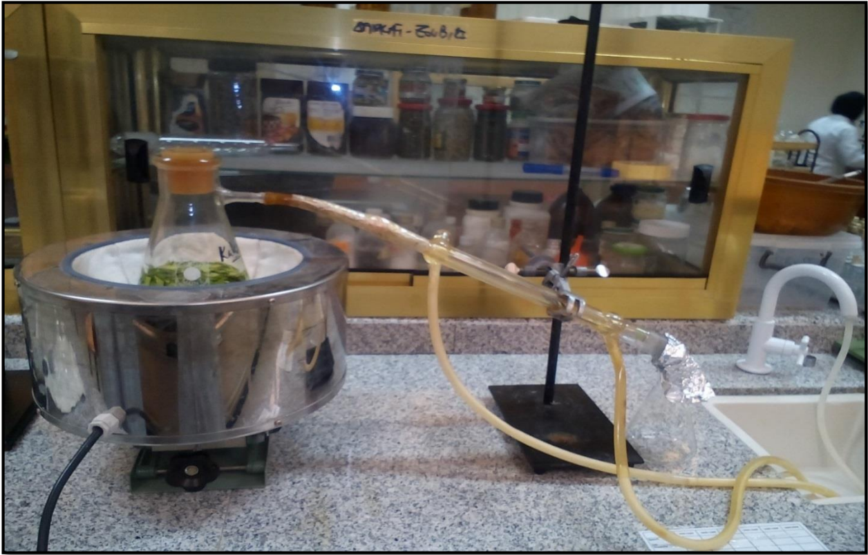
Figure 6 : Montage de l'hydrodistillateur de Citrus limon (feuilles)
