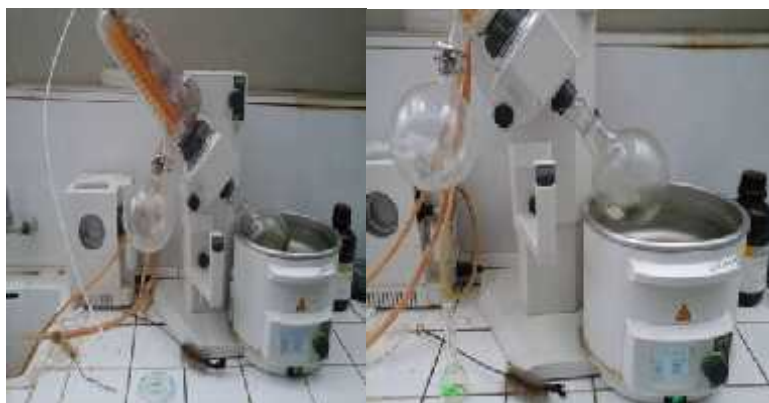
Figure 5 : Evaporation des échantillons à 60°C.
