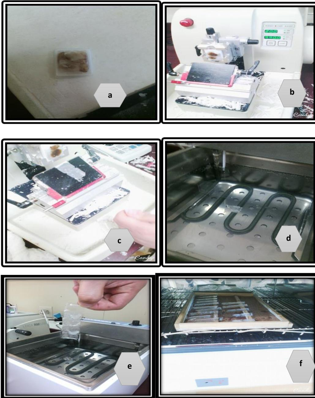
**Figure 10.** (a) Démoulage des cassettes; (b) Fixation des blocs dans le microtome; (c) Obtention des films; (d) Films plongés dans le bain Marie; (e) Récupérations des films par la lame; (f) Séchage des lames dans l'étuve.
