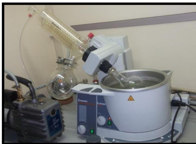
**Figure 10**: Evaporation sous vide a l'aide d'un rotavapeur
