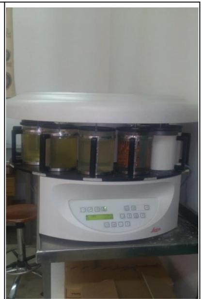
**Photo 04:** Un automate (Appareil de déshydratation)
