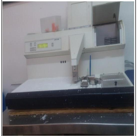
**Photo 05:** Appareil d'inclusion (ou d'enrobage) de marque Leica.
