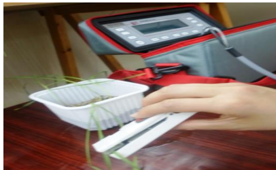
Figure. 14 :Mesure de la résistance stomatique
