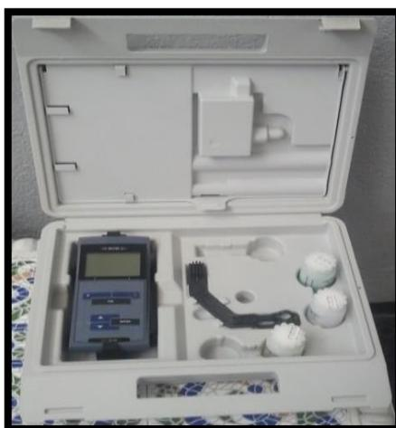
Figure 8 : pH mètre (WTW PH-3110)
