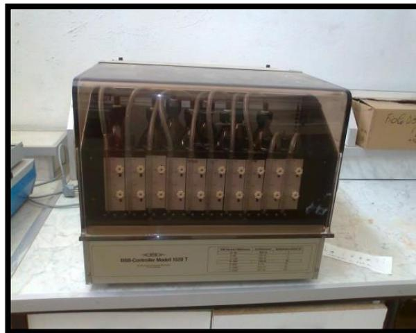
Figure 10 : appareil de type (WTW BSB-Controller Modell 1020 T)
